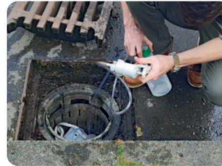
Wasserprobenentnahme im Straßenablauf
